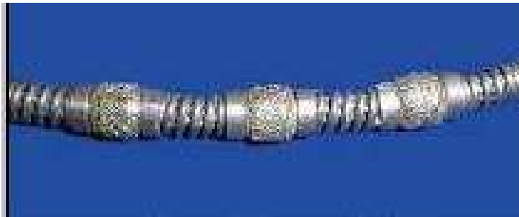
Figura 2. Fotografia di filo diamantato [3]
