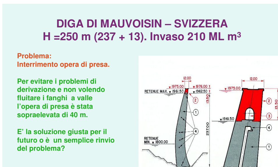
Fig. 4 – Schema della risoluzione dei problemi relativi ai sedimenti della Diga di Mauvoisin realizzata in Svizzera.
