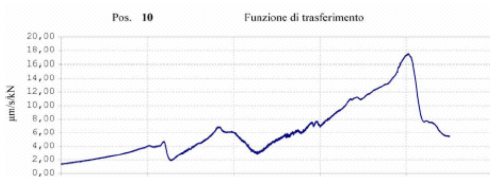
Figura 76 - Eccitazione V2R (livello di invaso 778.5m s.l.m.):funzione di trasferimento relativa alla posizione 10 sul coronamento
