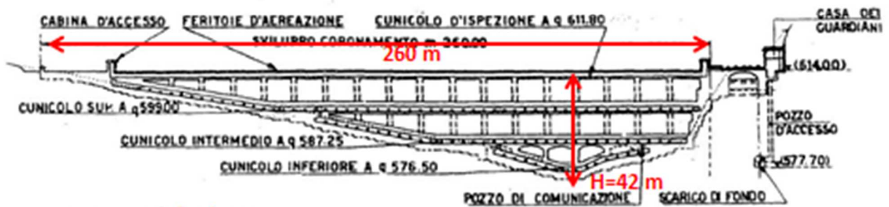
SEZIONE LONGITUDINALE LUNGO L'ASSE DEI CUNICOLI (VISTA DA VALLE)
