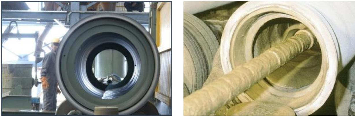
Figura 28 – Applicazione del rivestimento in cemento
