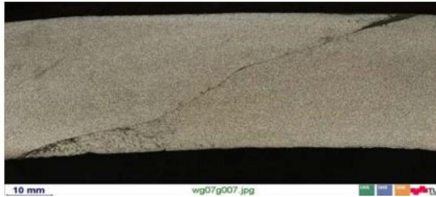
Figura 3 - Sezione di una saldatura al gas d'acqua
