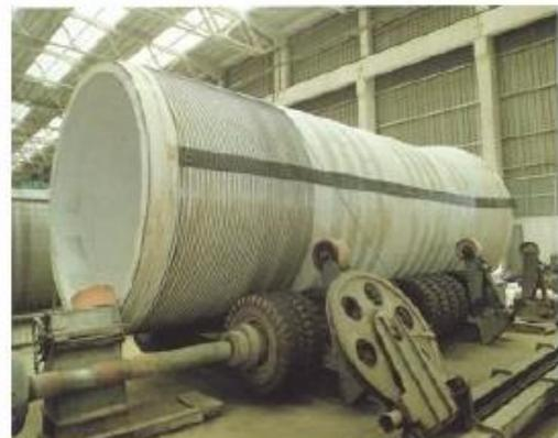
Figura 20 – Tubo in c.a.p. con armatura longitudinale e circonferenziale [9]
