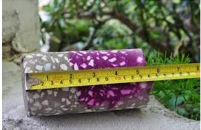
**Figura 105 – Prova di pull-out su calcestruzzo (sinistra) e prove di carbonatazione su una carota (destra)**
