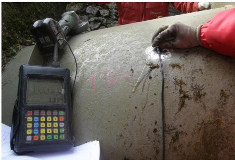
**Figura 119 - Esame spessimetrico mediante ultrasuoni [23]**
