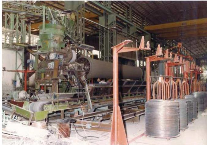
**Figura 21 – Tubi ad armatura diffusa in costruzione [12]**
