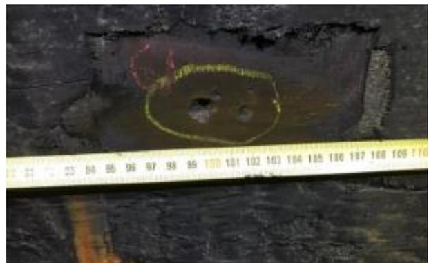
Figura 89 – Corrosione esterna in prossimità di una sella (sinistra) e fenomeno di *pitting* all'interno di una condotta di acciaio (destra)
