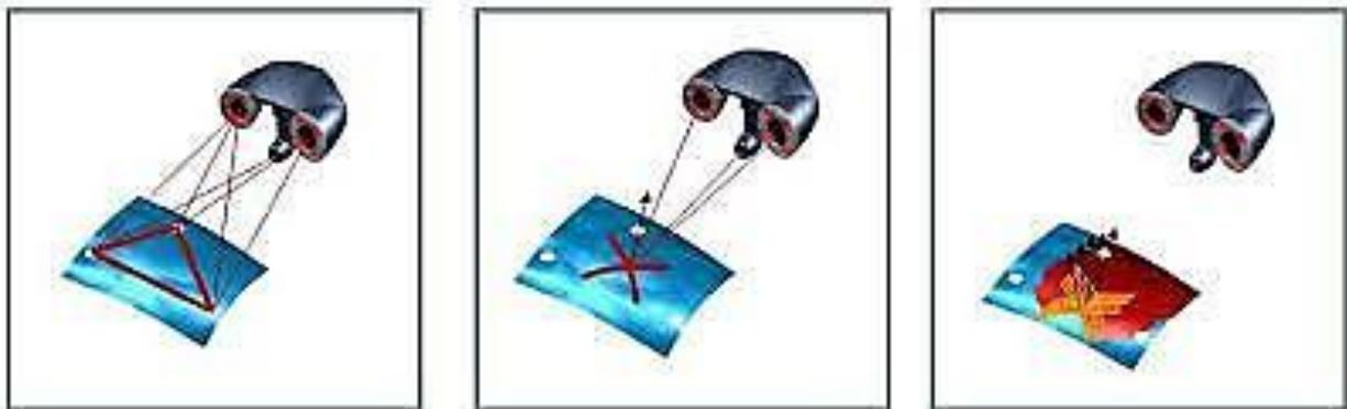
Figura 108 – Rilievo 3D mediante laser scanner ottico
