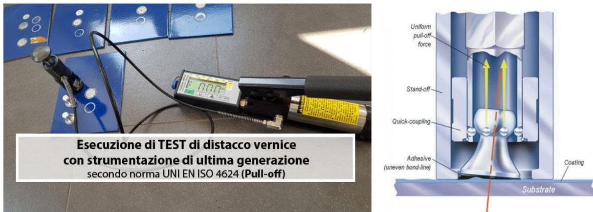
Figura 109 – Attrezzatura per eseguire prove di *pull-off* (sinistra) e principio di funzionamento (destra)
