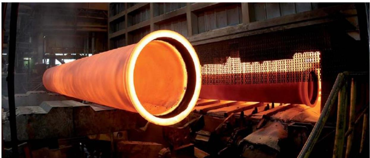
**Figura 27 – Fasi di ricottura delle tubazioni in ghisa**
