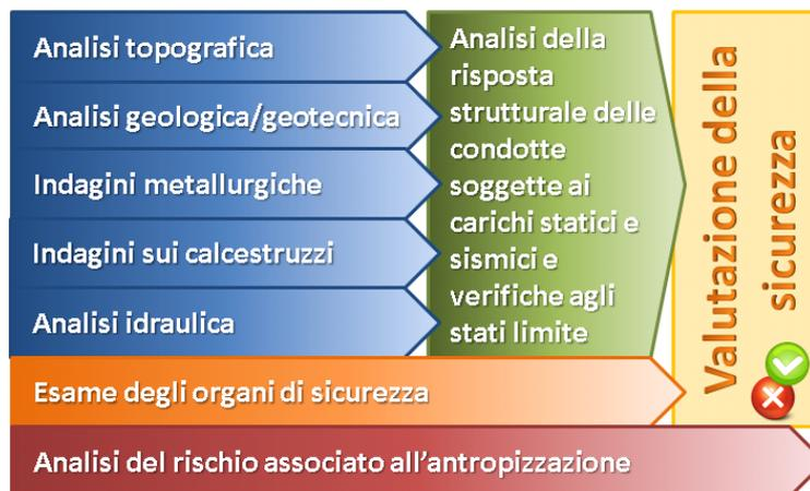
Figura 114 - Schema sintetico di valutazione della sicurezza di una condotta forzata
