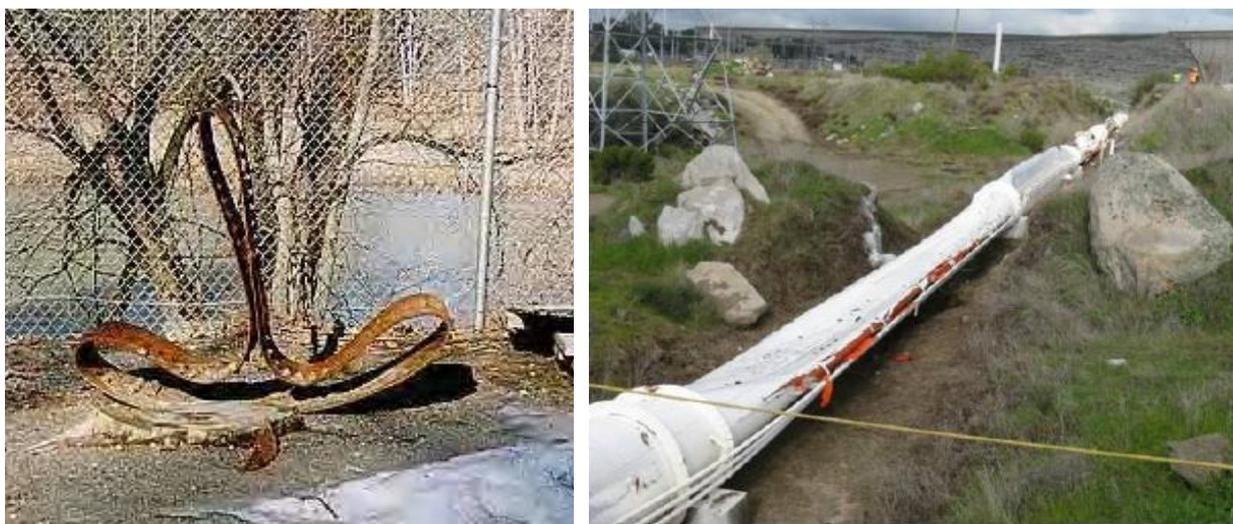
**Figura 142 – Accartocciamento delle condotte dovute a uno svuotamento rapido**
