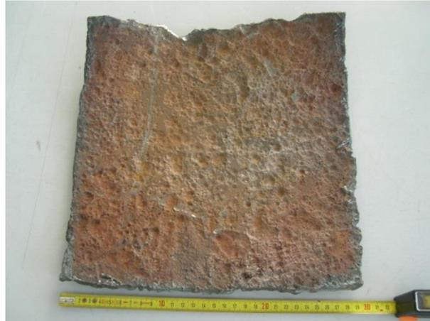
Figura 125 – Tallone prelevato da una condotta in esercizio con corrosione generalizzata
