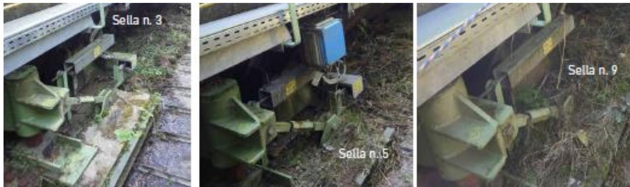
**Figura 112 – Selle con estensimetri in direzione monte-valle, destra-sinistra**
