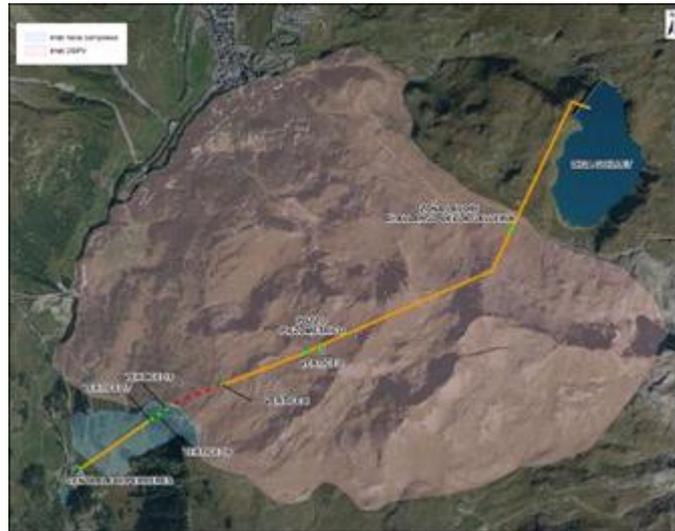
**Figura 154 – Estensione della DGPV di Cervinia e sua interazione con le opere di derivazione (linea gialla). Nel settore SW è indicata la frana “complessa” che interagisce con la parte terminale del tratto a forte pendenza della condotta forzata**
