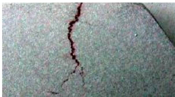
Figura 92 – Ispezione mediante liquidi penetranti
