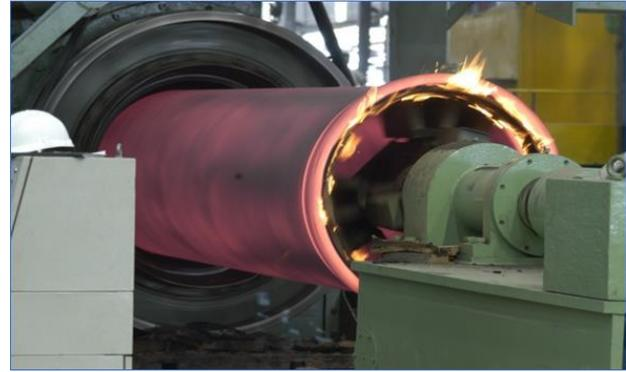
**Figura 26 – Fase iniziale di produzione delle tubazioni in ghisa nell'altoforno (sinistra) e fase di raffreddamento (destra)**
