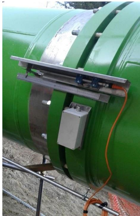
**Figura 113 – Esempio di deformometro per la misura dei movimenti del giunto**
