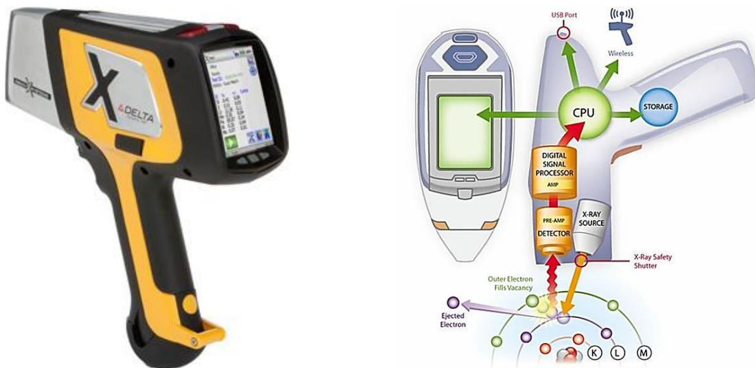
Figura 100 – Strumento per eseguire l'analisi chimica PMI (sinistra) e schema di funzionamento della prova (destra)
