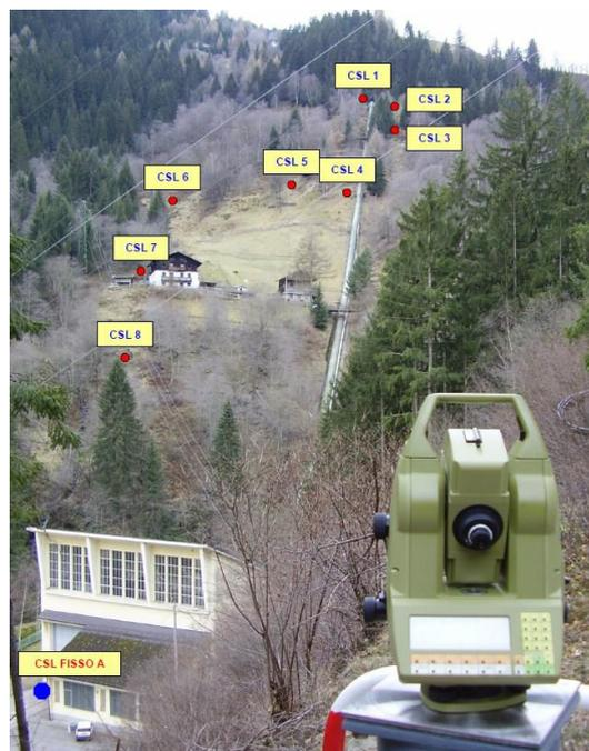
Figura 111 - Esempio di stazione topografica totale (questa finalizzata sia al controllo della condotta forzata sia ai movimenti del versante)
