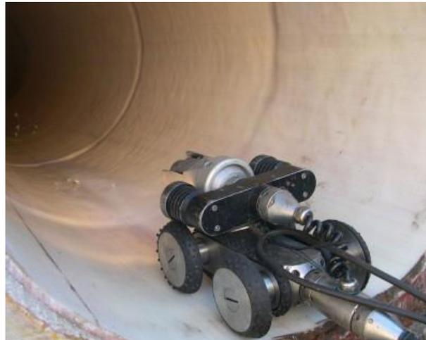
Figura 91 – Sistema robotizzato per le ispezioni interne
