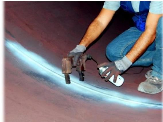
Figura 93 – Campo magnetico applicato con l'esame magnetoscopico
