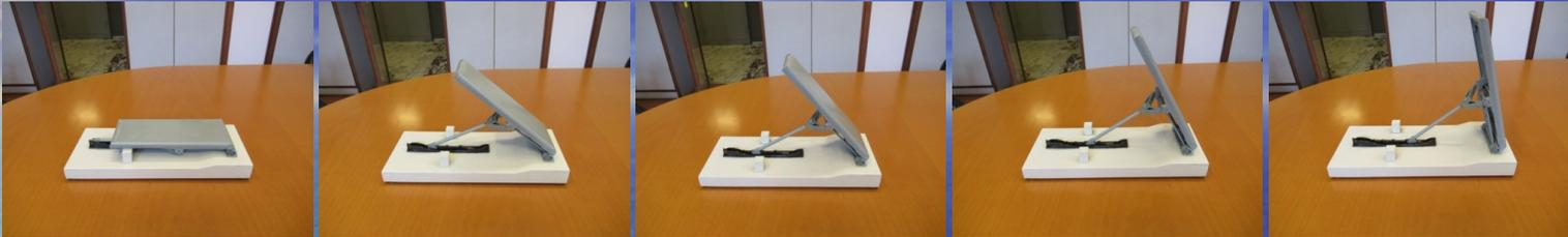
La manutenzione delle paratoie Chanoine è stata eseguita sino ad alcuni anni fa mediante palombari, eseguendo il posizionamento di un dispositivo di protezione idraulica, lo smontaggio della singola paratoia in acqua, il prelievo con carro di manovra, la sostituzione con paratoia di ricambio. La paratoia smontata veniva quindi trattata in officina (pulizia, sostituzione tenute laterali in lamierino, verniciatura, lubrificazione cerniere) e posta in deposito per il reimpiego successivo.
