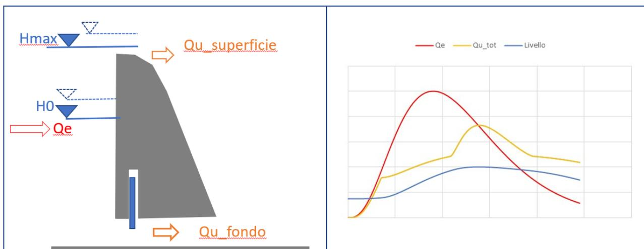
Fig.2d – Laminazione di una generica onda di piena con un livello inferiore rispetto a quello iniziale di Fig.2c
